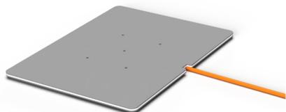
Le capteur DALLE est sensible à des micro-variations de pression et enterré à une profondeur de cinq centimètres. Il détecte les pas. Un système de temporisation permet de ne compter qu'une personne même si elle fait deux pas sur la DALLE. Dans le cas de passages larges, les dimensions et l'espacement des DALLE entre elles permettent de compter plusieurs personnes de front en maintenant une précision à +/- 5 %.
