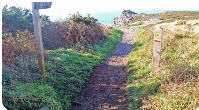
Deux capteurs DALLE à la suite l'un de l'autre permettent de connaître la direction des promeneurs. Le capteur étant enterré, il ne dénature pas le paysage. La temporisation de l'algorithme compte une personne même si elle fait deux pas sur le capteur.
