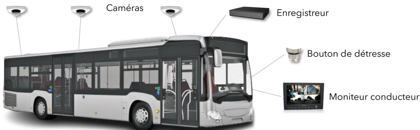
Au cœur de tout système de vidéoprotection, les **caméras**, en plus de leur effet dissuasif, captent les flux vidéo et audio à bord des véhicules.
